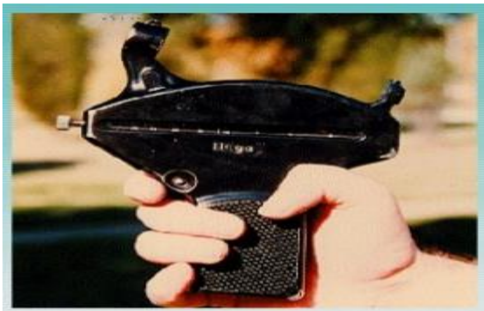
Hipsómetro haga, equipo utilizado para medir la altura de los arboles
