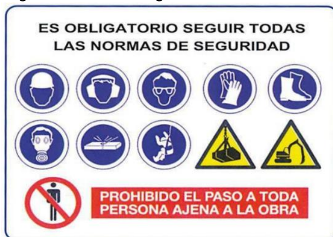
Figura 1.7 Señales de Seguridad de Protección Personal
