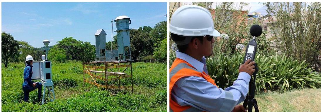
*Imagen. Monitoreo de calidad de aire (material particulado) y ruido*
