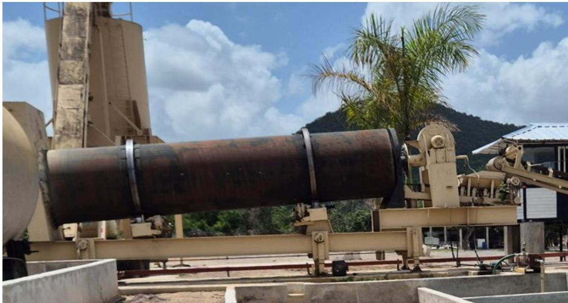
**Figura No. 26.- Horno mezclador.**
