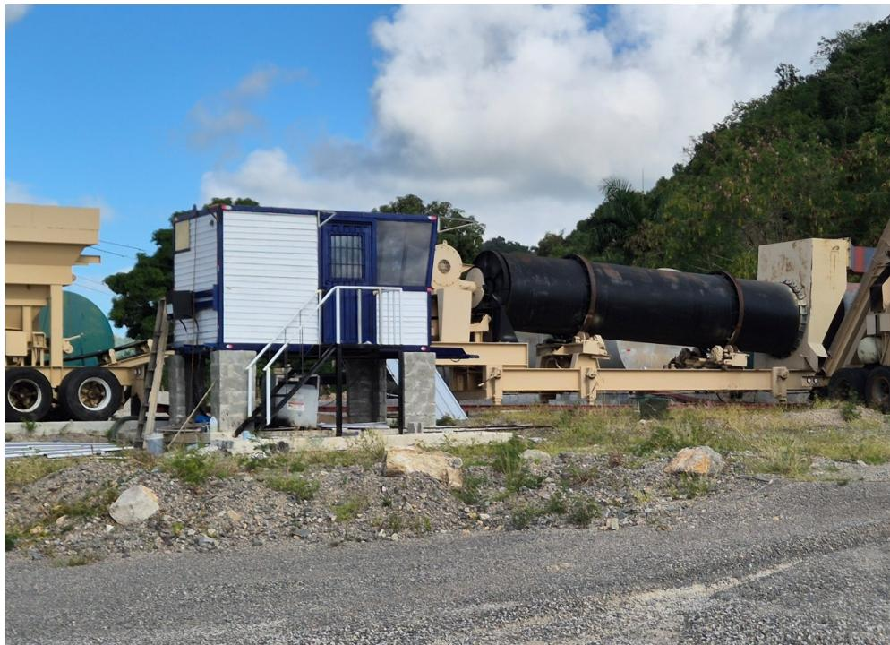
**Figura No. 19.- Cabina de control y horno.**
