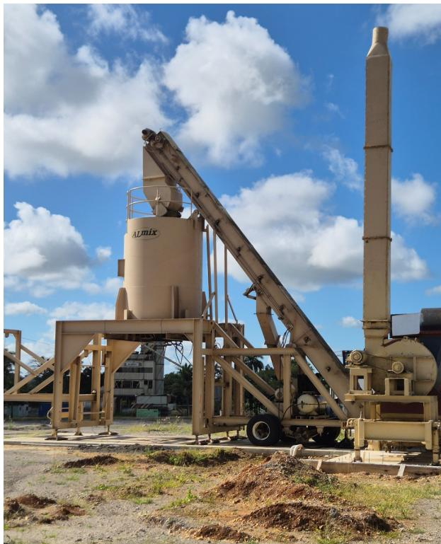
**Figura No. 20.- Silo y área de descarga del asfalto a los camiones.**
