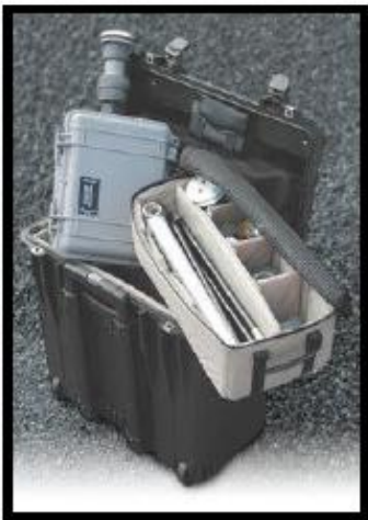
Fotos 1 y 2 – Air Metrics, equipo de medición partículas.
