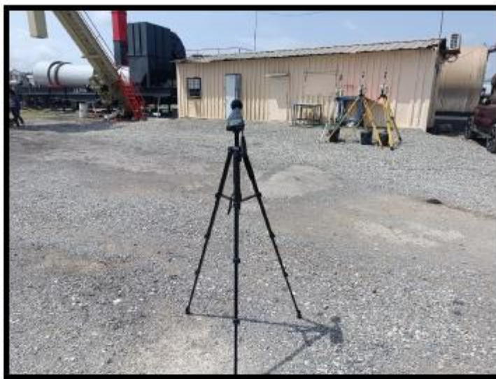
Foto 1: Evaluación de ruido ambiental en el punto RA-1- Perímetro sureste próximo a oficina y laboratorio. UGR (UTM): 19 Q 372864 m E 2177225 m N.
