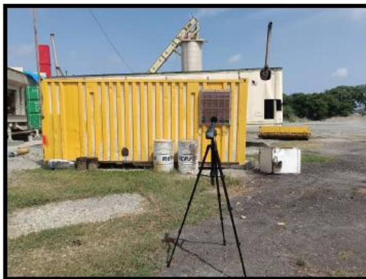
Foto 2: Evaluación de ruido ambiental en el punto RA-2- Próximo a generador eléctrico encendido. UGR (UTM): 19 Q 372844 m E 2023532 m N.
