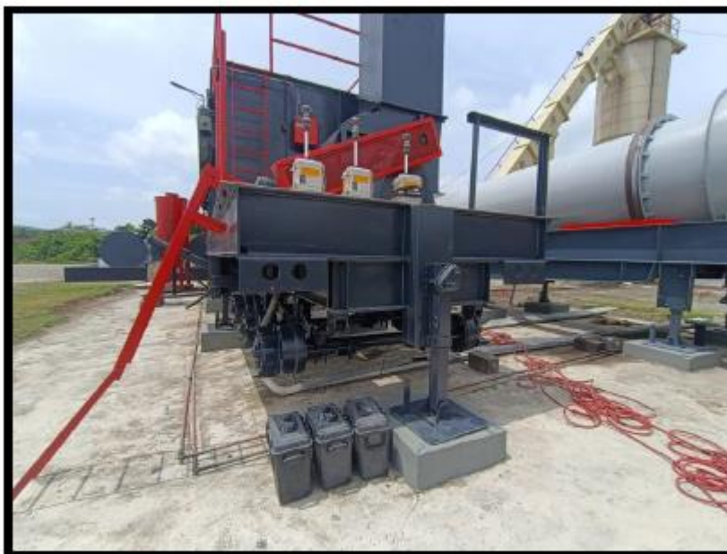
Foto 2: Evaluación de inmisión de partículas suspendidas, EM-2- Perímetro noreste próximo a tolva de agregados. UGR (UTM): 19 Q 372866 m E 2023543 m N
