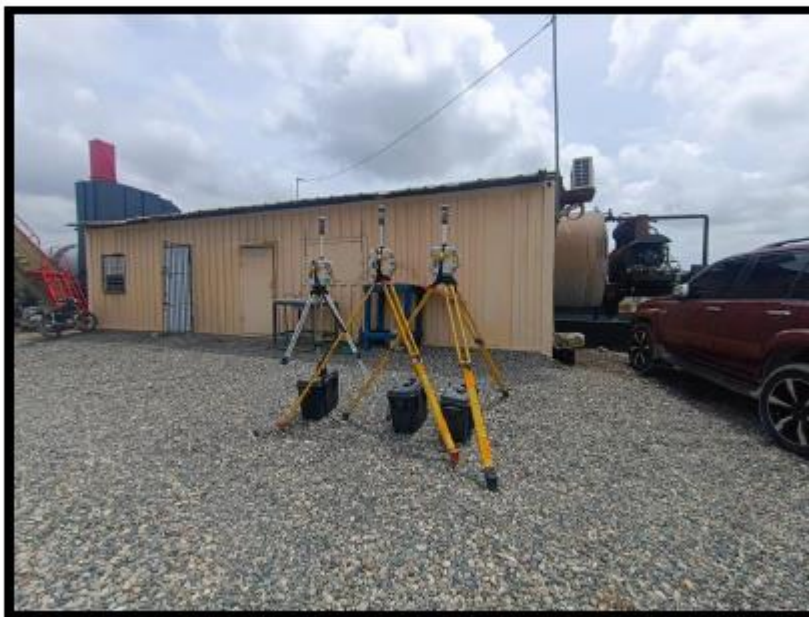
Foto 1: Evaluación de inmisión de partículas suspendidas, EM-1- Perímetro sureste próximo a oficinas. UGR (UTM): 19 Q 372857 m E 2023494 m N.
