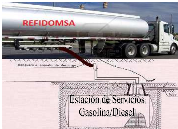
Proceso de llenado del tanque de combustible
