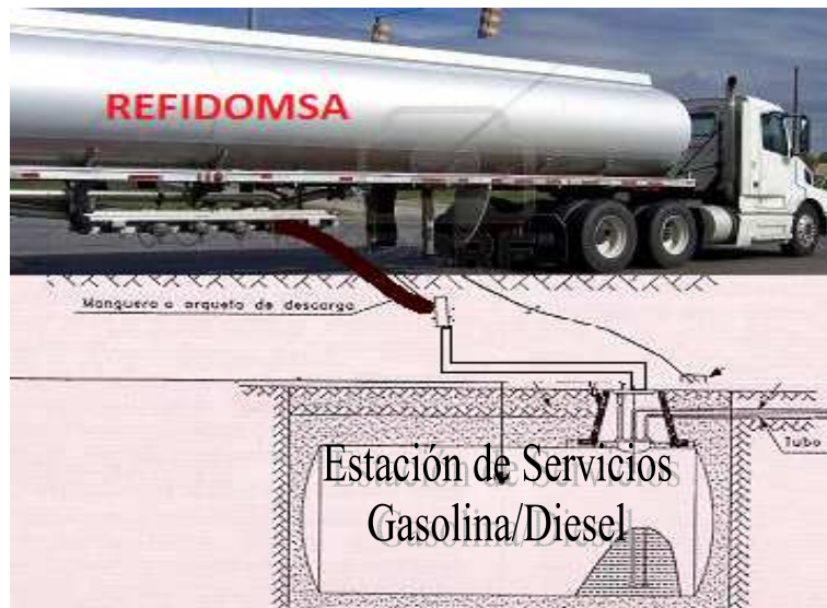
Proceso de llenado del tanque de combustible
