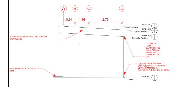
(D)(C) A (**B**) CUBREFALTA SIMULANDO ANTEPECHO, DENSGLASS 2.75 1.16 0.94 VENTADAS ABATIBLES DE CRISTAL Cubrefalta frontal CAPTACIÓN DE AGUA PLUVIAL, Cubrefalta Posterior METAL TIPO U, DIAMETRO 15 // PINTURAL COLOR MAIZ TOSTADO 137, ACRILICA TUBO DE DESAGÜE PARA CAPTACIÓN DE AGUA PLUVIAL, METAL, DIAMETRO 3". EXTENDER TUBO 80 CM EN SUELO NIVELAR ACERA EXISTENTE 2 M3 - · NPT 0.0
