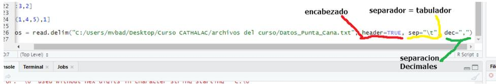
Ilustración 6.a Detalle del significado de los elementos de la línea de código
